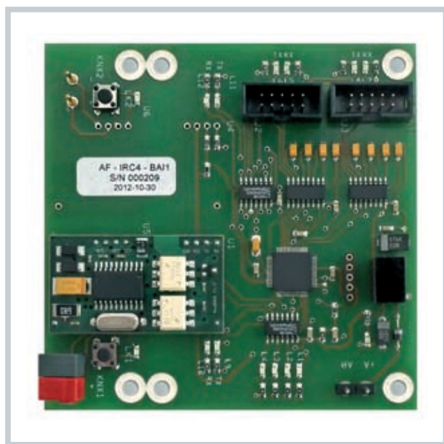
Rys. 5. Płytkę interfejsu włączaną pomiędzy magistralę KNX a centralę Concept 4000
