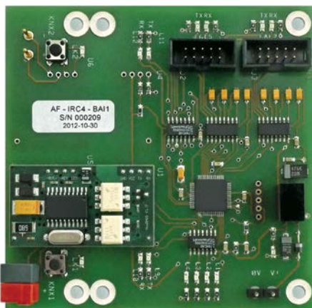
Rys. 2. Płytki interfejsu włączana pomiędzy magistralę KNX a centralę Concept 4000
