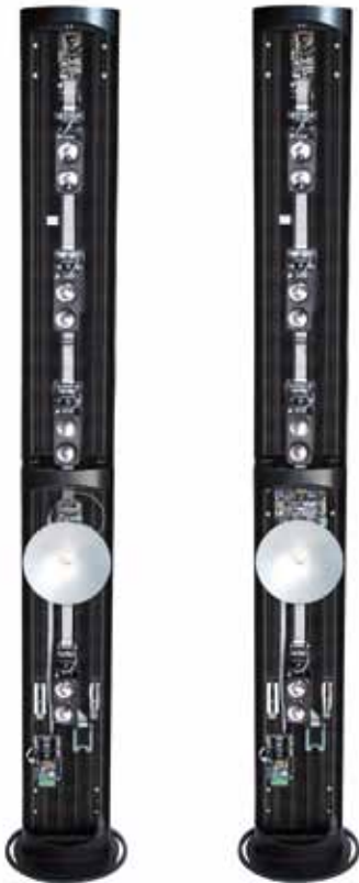
Rys. 8. Wnętrza kolumn nadawczej i odbiorczej bariery dualnej Źródło: Politec Srl
