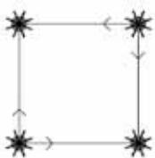
Rys. 2b. Oszczędne projektowanie barier podczerwieni z wykorzystaniem detektorów nacisku
