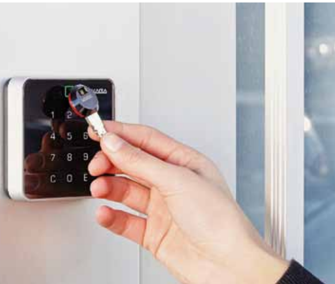
Rys. 7. Transponder w główce klucza, używany do identyfikacji w systemie kontroli dostępu
