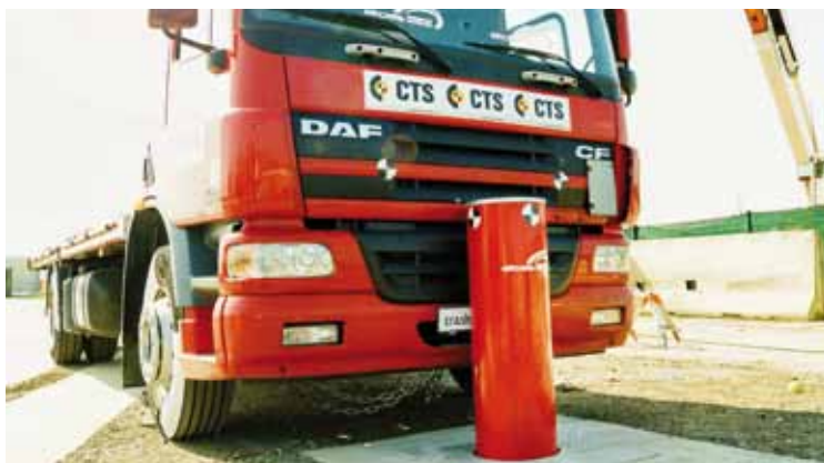
Rys. 2. Pachotek antytaranowy typu M50 przed i po teście najazdowym Zdjęcia – Gunnebo Polska
