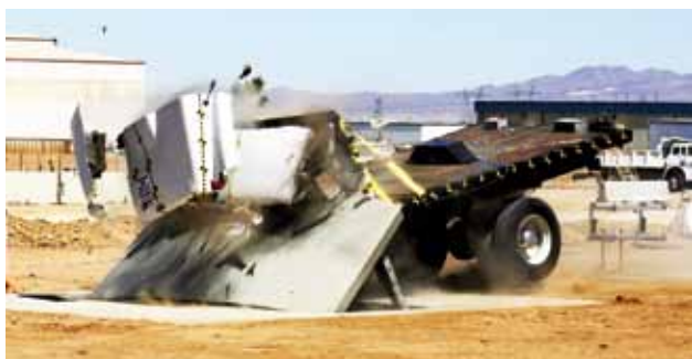
Rys. 1. Zapory klinowe podnoszone z poziomu drogi typu Wedge w czasie badania najazdowego i w obszarze miejskim Zdjęcia – Gunnebo Polska
