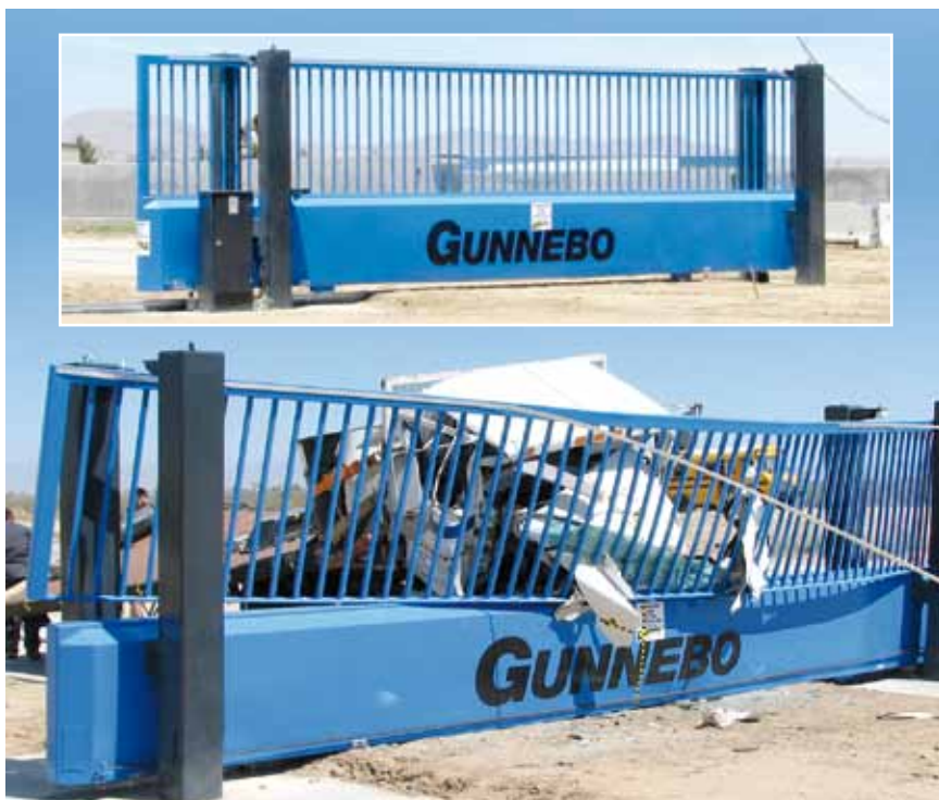
Rys. 3. Brama Tracking Gate M50 przed i po teście najazdowym Zdjęcia – Gunnebo Polska
