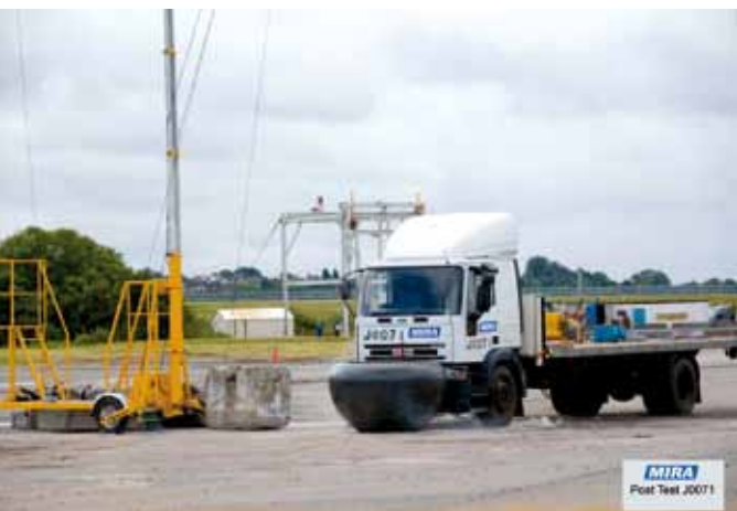
Test najazdowy donicy RhinoGuard™ 75/50 (ciężarówka o masie 7,5t nadjeżdża z prędkością 80 km/h)
