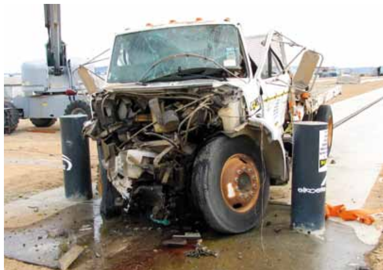
Rys.6. Badanie pacholków antyterrorystycznych – ciężarówka po teście najazdowym
