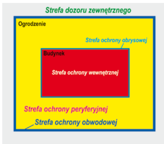
Rys. 4.1. Strefy ochrony budynku bez wydzielonej strefy podejścia
