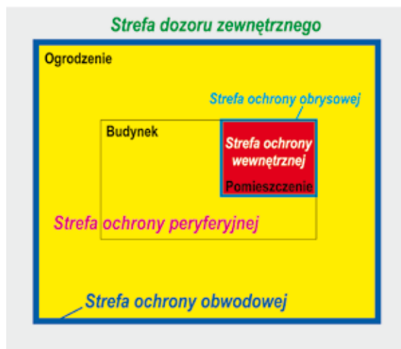
Rys. 3.1. Strefy ochrony pomieszczenia bez wydzielonej strefy podejścia
