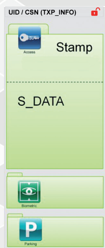
Rys. 3. Przykładowy model struktury wewnętrznej karty pracującej na 13,56 MHz – niekodowany numer UID (CSN)
