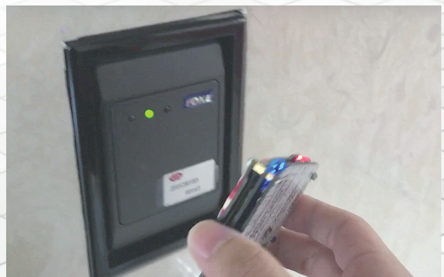
Rys. 2. Urządzenie do duplikowania kart: odczyt zawartości pamięci karty i otwarcie przejścia bez produkcji duplikatu karty
