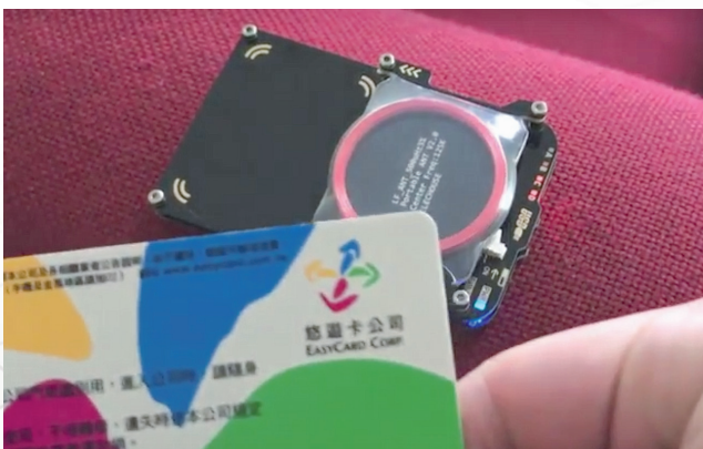
Rys. 2. Urządzenie do duplikowania kart: odczyt zawartości pamięci karty i otwarcie przejścia bez produkcji duplikatu karty
