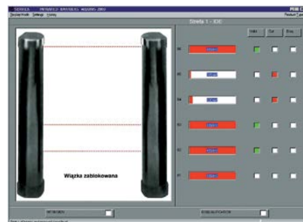
Rys. 7. Podgląd działania barier w systemie firmy Sorhea – wiązka 1. zablokowana, problem z 4. i 5. wiązką
