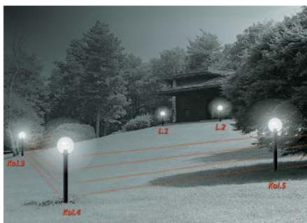
Rys. 9. Graficzna wizualizacja systemu ochrony obwodowej wykorzystującej bariery podczzerwieni firmy Politec, zamaskowane w latarniach
