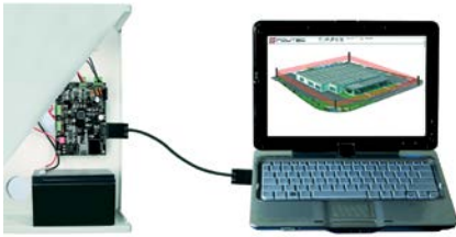
Rys. 8. Koncentrator Adebis systemu ochrony obwodowej firmy Politec, do którego podłącza się komputer i wejścia centrali alarmowej
