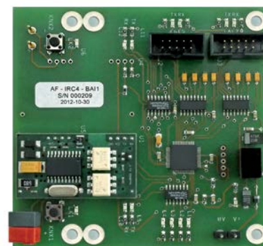
Rys. 4. Płytkę interfejsu włączana pomiędzy magistralę Concept 4000 a centralę
