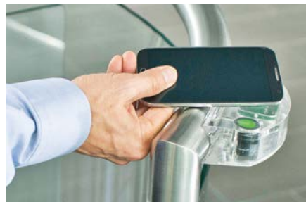
Rys. 3. Identyfikacja przy użyciu telefonu komórkowego z technologią NFC
