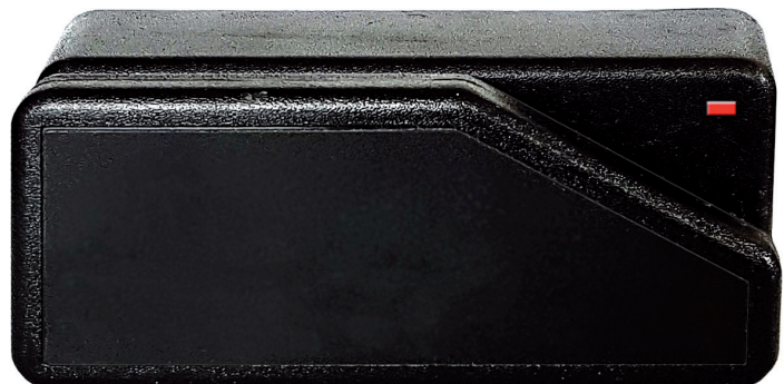
Rys. 2. Czytnik kart Wieganda wyprodukowany w 1993 r. w amerykańskiej firmie Sensor Engineering – w czasie odczytu kartę przesuwano się poziomo
