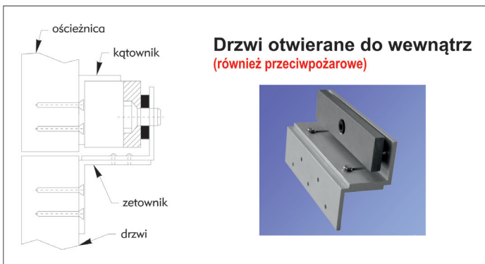
Rys. 7. Metody montażu elektromagnesów drzwiowych (zwór elektromagnetycznych) – z zaznaczeniem, który typ montażu jest zalecany do drzwi przeciwpożarowych
