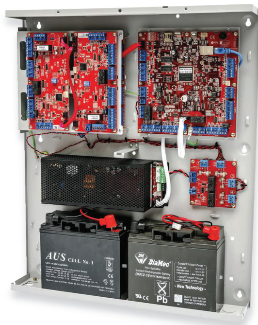
IAC w konfiguracji 8 przejść/10 czytników (IAC z podłączonym rozszerzeniem UniBus 2 przejścia/2 czytniki). Obudowa WideBody, zasilacz 8A, moduł przełącznikowy wykorzystywany w systemach przeciwpożarowych 2 x akumulator 17Ah.
