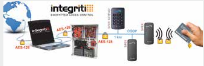
Rys. 7. Pełne szyfrowanie całego systemu kontroli dostępu w INTEGRITI – 4. stopień zabezpieczenia wg PN-EN 60839-11-1
