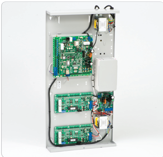
Rys. 3. Schemat podłączenia central alarmowych innych producentów, zainstalowanych wcześniej w placówkach banku w celu umożliwienia zarządzania wszystkimi obiektami z tego samego oprogramowania Insight Professional oraz widok wnętrza centrali IP firmy Inner Range wykorzystywanej do tego celu
