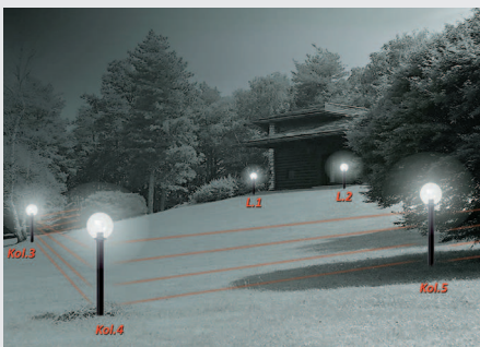
Rys. 9. Graficzna wizualizacja systemu ochrony obwodowej wykorzystującej bariery podczerwiieni firmy Politec, zamaskowane w latarniach
